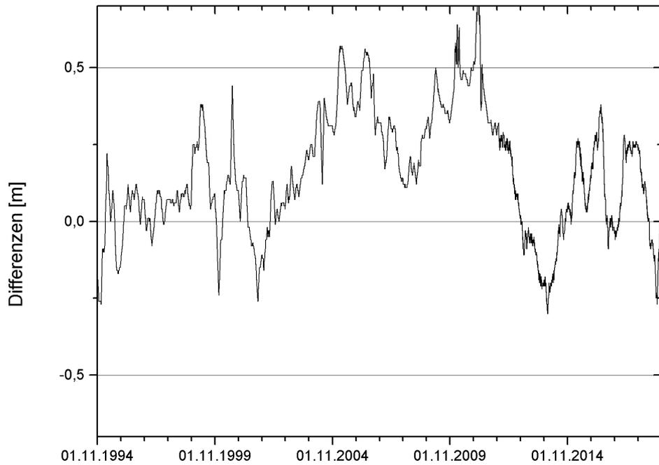
Gemessene und mit Hilfe des Wiener Filter Verfahrens simulierte Grundwasserstands-entwicklung an der Referenzmessstelle 907751
