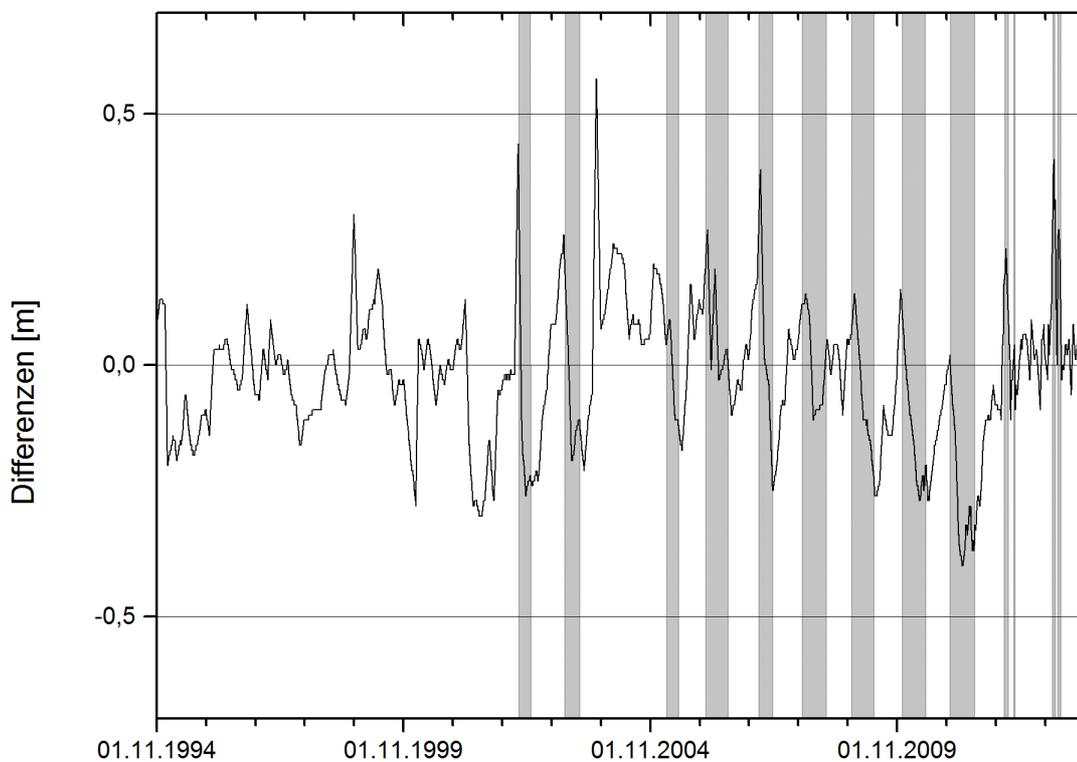
Abbildung 6: Gemessene und mit Hilfe des Wiener Filter Verfahrens simulierte Grundwasserstandsentswicklung sowie Grundwasserstandsdifferenz an der Messstelle 907641. Die grauen Balken kennzeichnen Förderzeiträume.
