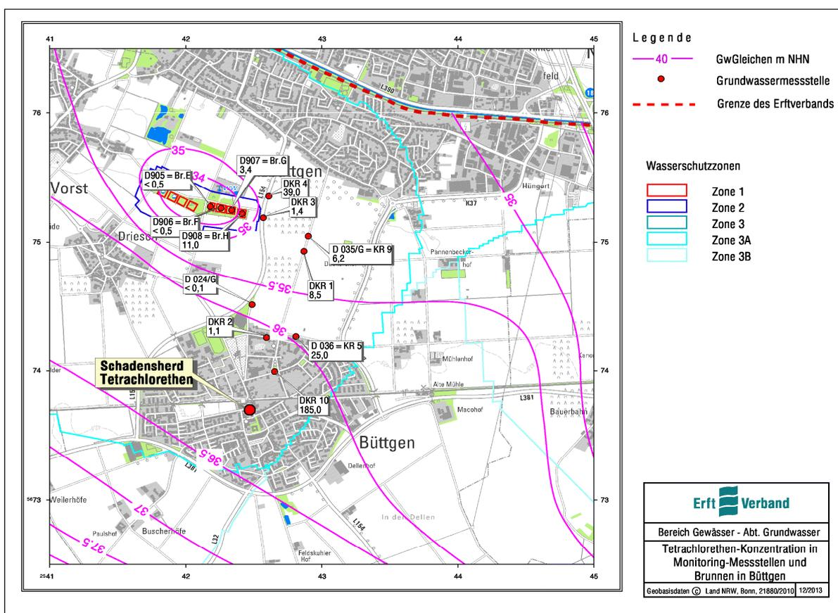
Abbildung 8: Messstellen für das Grundwassermonitoring im Zusammenhang mit dem LHKW-Schadensfall in Kaarst-Büttgen. Dargestellt sind die Messstellennummern und die im Frühjahr 2013 gemessenen Tetrachlorethenkonzentrationen in µg/l. Die Grundwassergleichen geben die Situation vom Oktober 2012 wieder.
