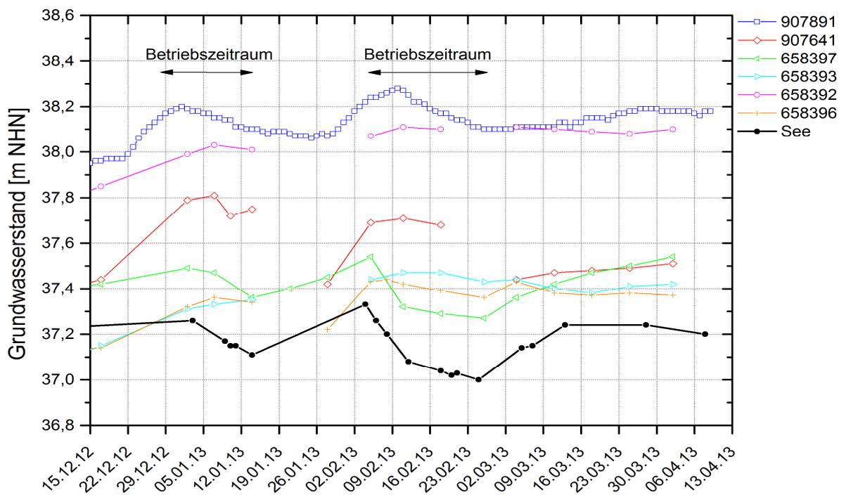
Abbildung 4: Entwicklung der Grundwasserstände und des Seespiegels (Messstellennummer 909461) im WWJ 2013
