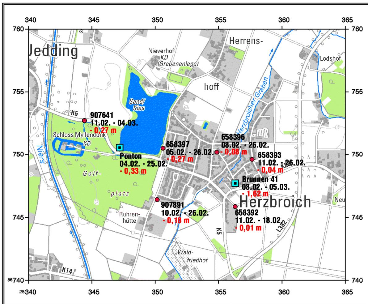
Abbildung 7: Grundwasserdifferenzen zwischen dem höchsten gemessenen (Anfang Februar 2013) und dem abgesenkten Grundwasserstand nach Beendigung der Förderung Ende Februar 2013.
