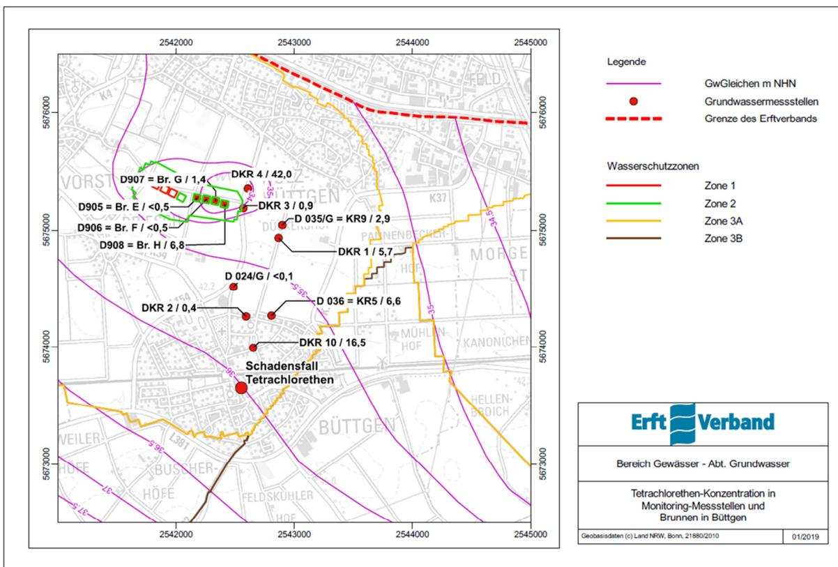
Abbildung 8: Messstellen für das Grundwassermonitoring im Zusammenhang mit dem LHKW-Schadensfall in Kaarst-Büttgen. Dargestellt sind die Messstellennummern und die im Frühjahr 2018 gemessenen Tetrachlorethenkonzentrationen in µg/l. Die Grundwassergleichen geben die Situation vom Oktober 2017 wieder.
