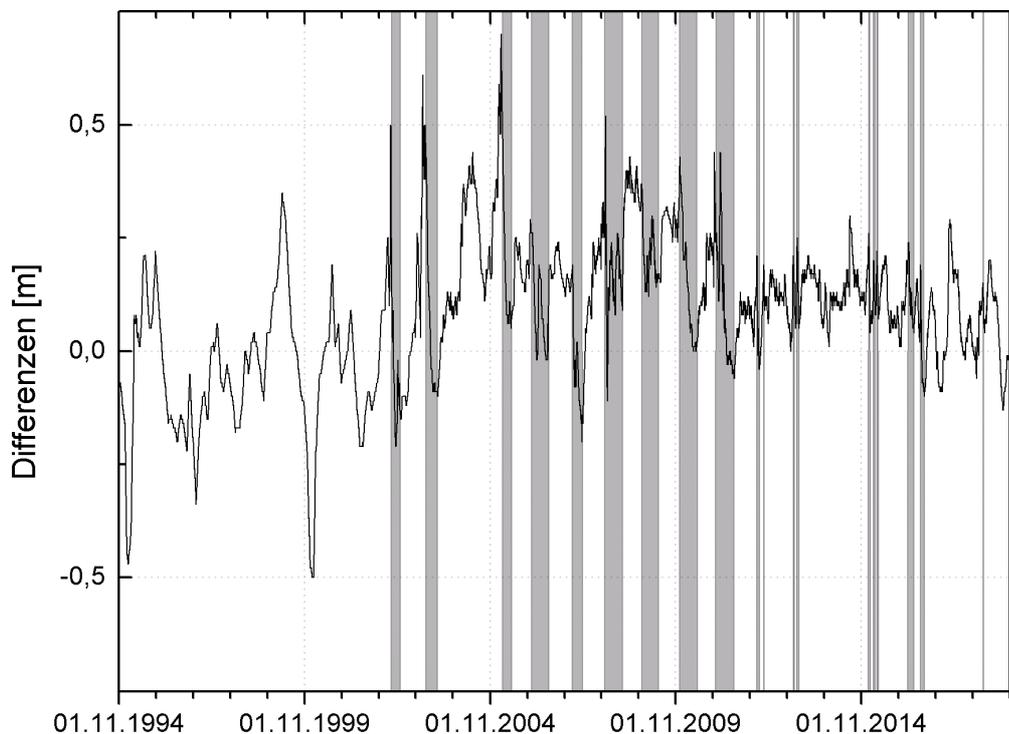
Abbildung 5: Gemessene und mit Hilfe des Wiener Filter Verfahrens simulierte Grundwasserstandsentwicklung sowie Grundwasserstandsdifferenz an der Messstelle 907891. Die grauen Balken kennzeichnen Förderzeiträume.
