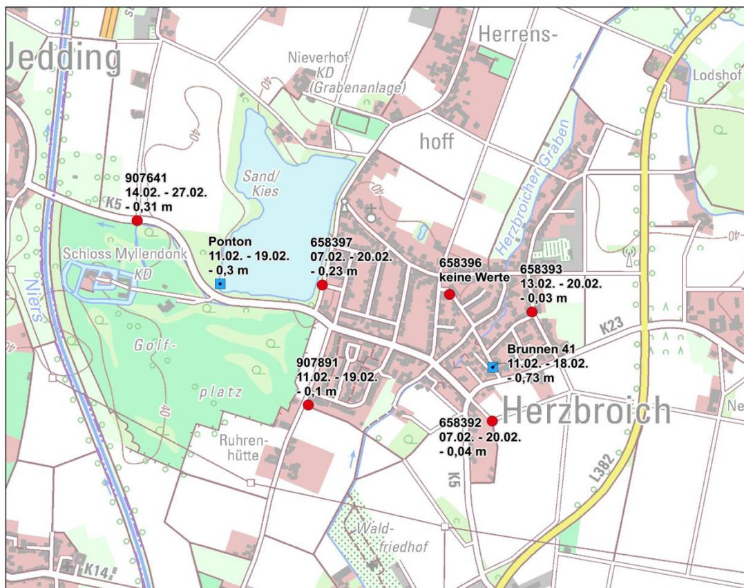
Abbildung 7: Grundwasserdifferenzen zwischen dem höchsten gemessenen Grundwasserstand während der Kappungsmaßnahmen im WWJ 2018 und dem abgesenkten Grundwasserstand nach Beendigung der Förderung.
